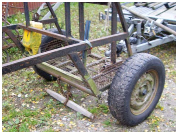
Bild 5. Stela skaklar försedd med svängel och draglinor
